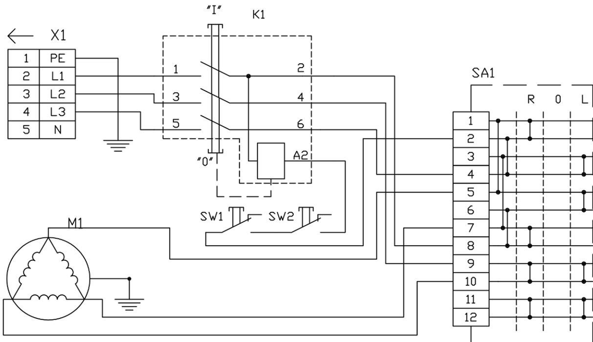
SW1 - Концевой выключатель защитного стекла
